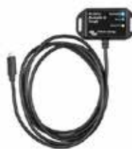
Mit dem energiesparenden VE.Direct zu Bluetooth Smart Dongle lassen sich Daten und Alarime in Echtzeit auf Apple und Android Smartphones, auf Tablets, Macbooks sowie auf anderen Geräten anzeigen.
