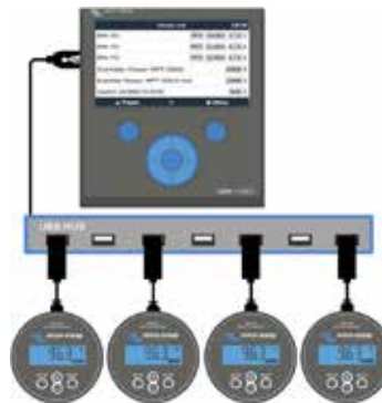
Es können bis zu vier BMVs direkt mit einem Color Control verbunden werden. Es lassen sich sogar noch mehr BMVs an einen USB-Hub anschließen, um zentral überwacht zu werden.
