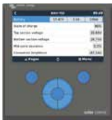
Color Control Der leistungsstarke Linux-Computer, versteckt hinter dem Farbdisplay und Tasten, sammelt Daten von allen Victron-Geräten und zeigt sie auf dem Display an. Abgesehen von dem Datenaustausch mit den Victron-Geräten kommuniziert das Color Control außerdem über NMEA2000, Ethernet und USB.
